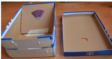
Spektroskop mit Rampe, Spalt und Guckloch (Deckel)
